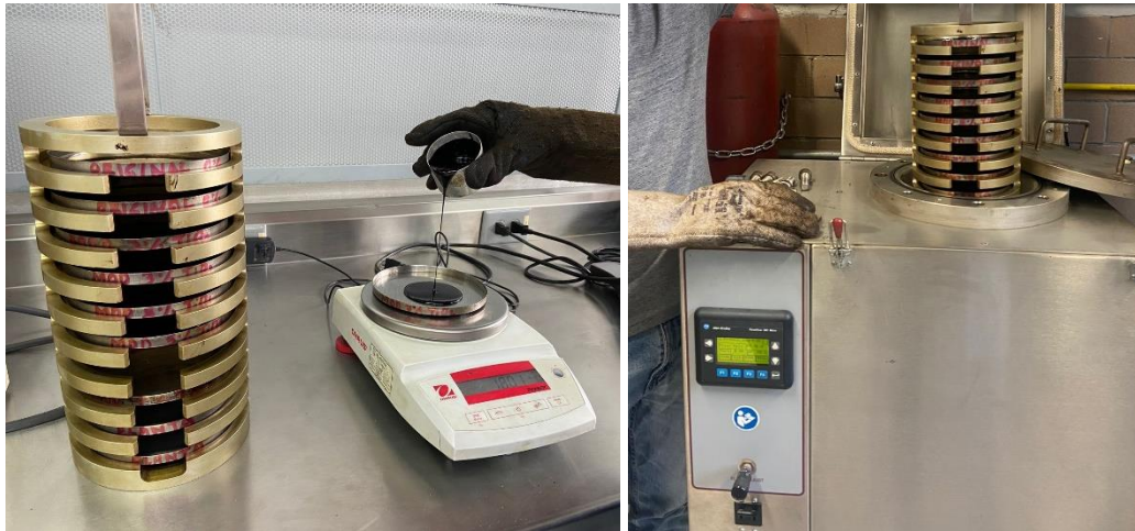
Figura 2. Envejecimiento a largo plazo en la vasija de envejecimiento a presión, PAV.
