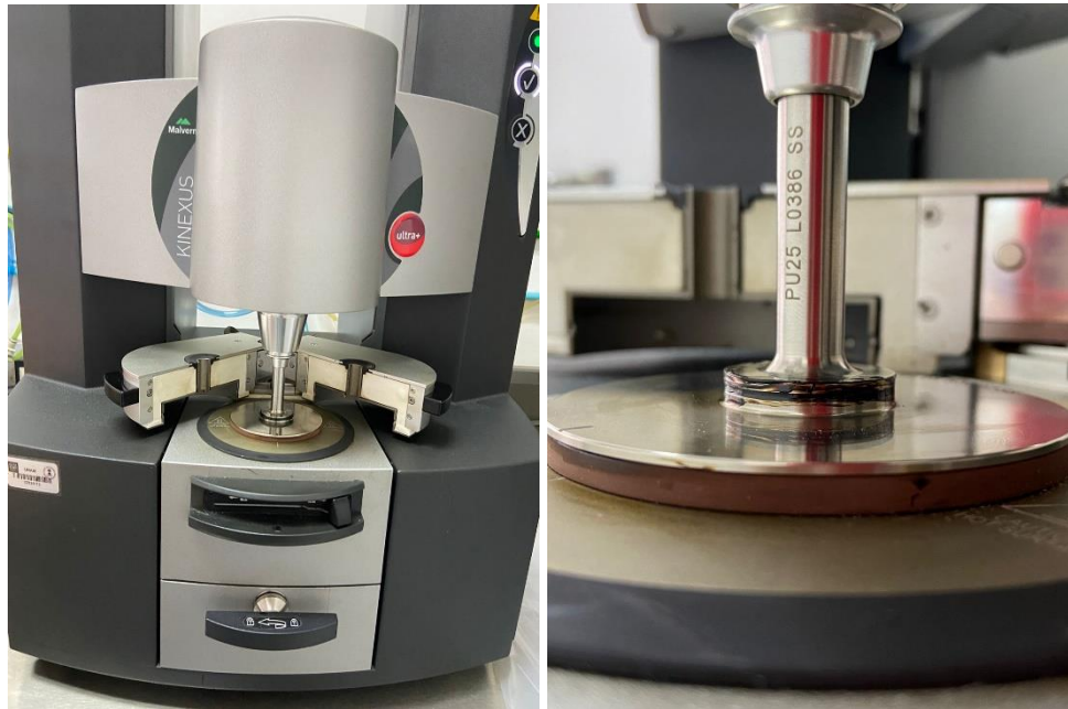
Figura 4. Reómetro de corte dinámico, muestra de CA-Con, obtención del grado de rendimiento PG Superior.
