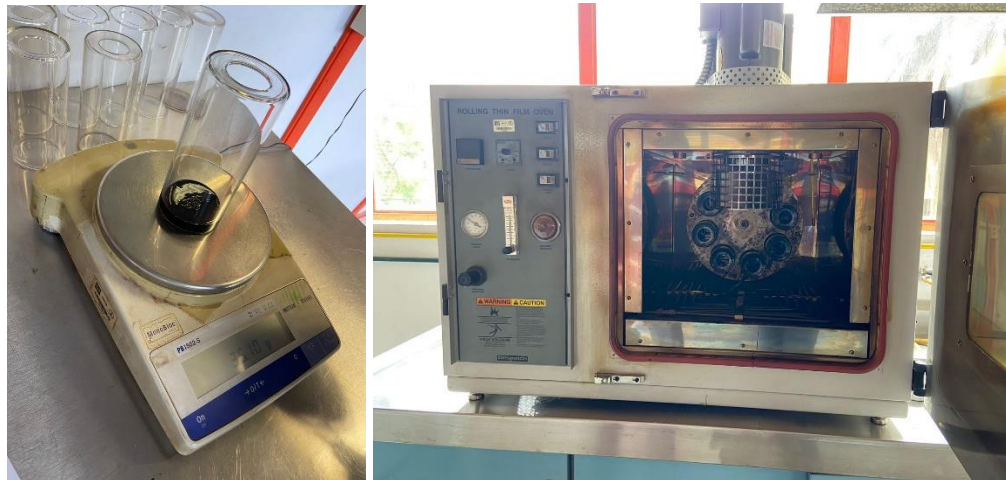
Figura 1. Envejecimiento a corto plazo por horno rotatorio de película delgada, RTFO.
