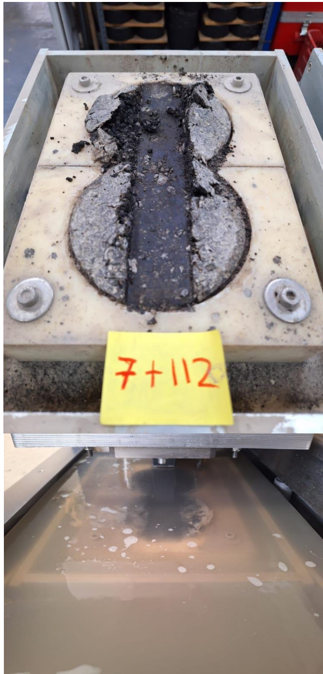
Figura 3. Especímenes evaluados en prueba de Rueda Cargada de Hamburgo
