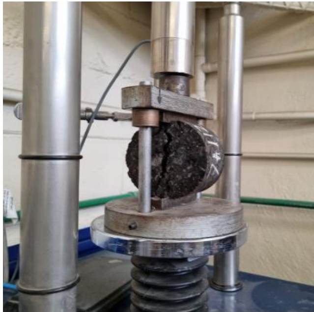
Figura 1. Especímen evaluado en prueba de TSR
