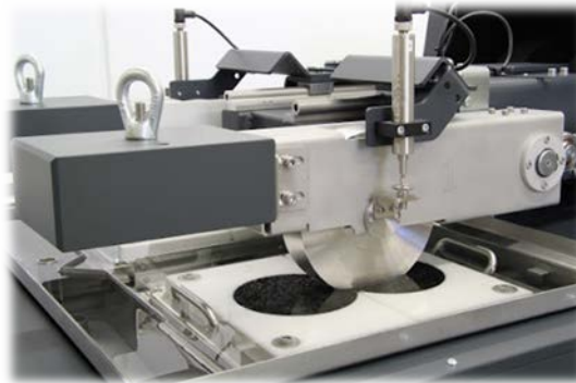
Figura 6. Esquema de dispositivo Rueda Cargada para ensayo de probetas. HWTT.
