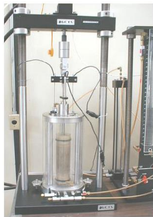
Figura 6. Equipo triaxial para determinar el módulo de resiliencia
