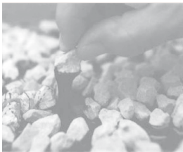
Figura 1. Elasticidad del ligante residual de una emulsión modificada.
