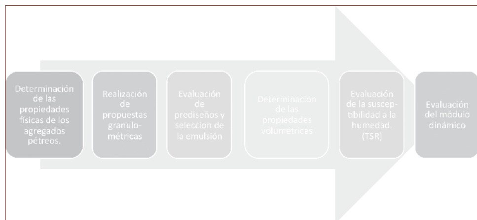
Figura 1. Diagrama de proceso del diseño de la mezcla asfáltica en frío.
