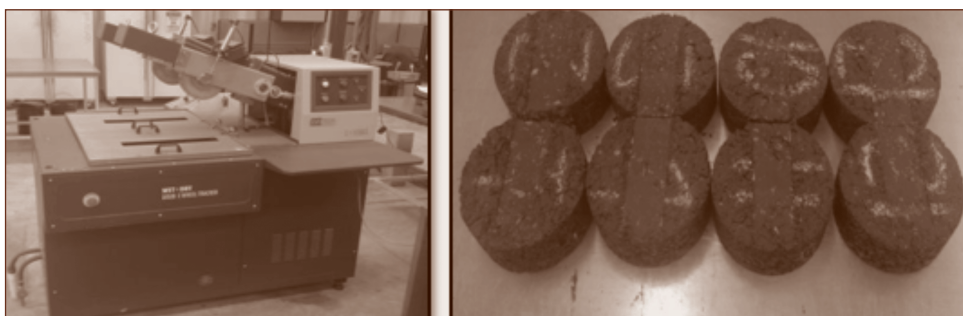
Figura 6. Equipo de rueda cargada de Hamburgo y probetas después del ensayo.
