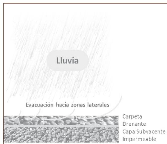
Figura 1. Esquema de mezcla drenante.
