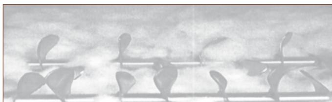
Figura 2. Dispositivo mecánico para la dispersión y dosificación de la fibra.
