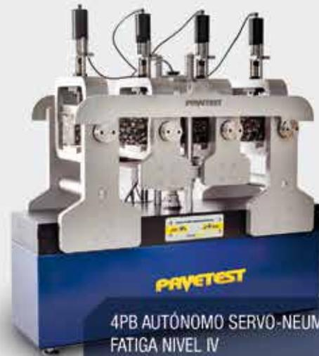
4PB AUTÓNOMO SERVO-NEUMÁTICO,
