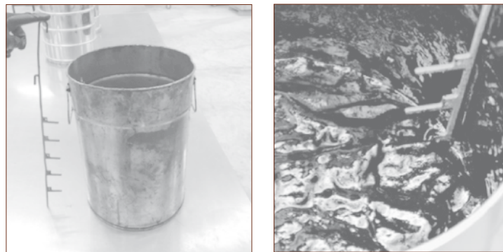
Figura 2. Varilla y cubeta de medición para asfalto espumado.
