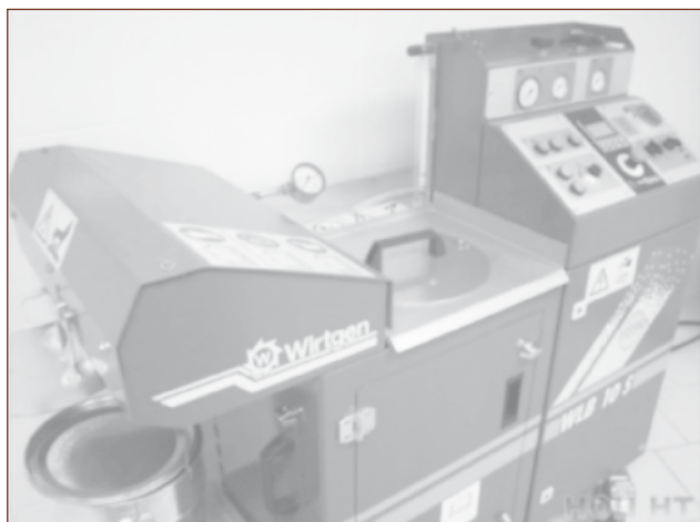
Figura 1. Equipo de laboratorio Wirtgen WLB-10s, cámara de expansión para asfalto espumado.
