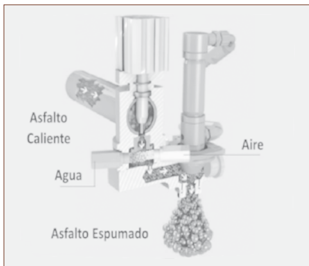
Figura 1. Equipo de laboratorio Wirtgen WLB-10s, cámara de expansión para asfalto espumado.
