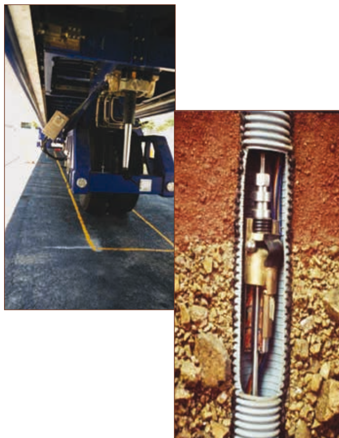
Figura 3. Sección de ensayo con el HVS (a), Esquema de un MDD (b)
