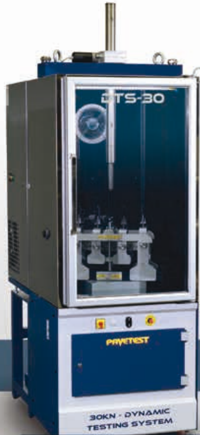
PRENSA SERVO-HIDRÁULICA 30 KN, MÓDULO DINÁMICO (NIVEL III)
