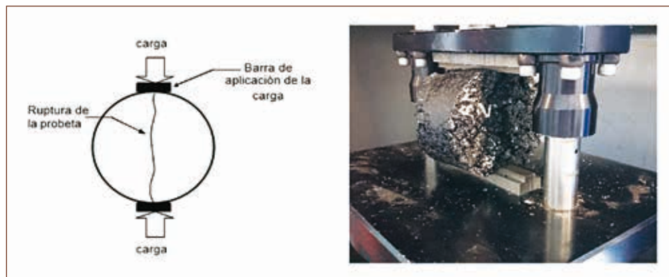
Figura 3. Ensayo de energía de fractura por tracción indirecta.
