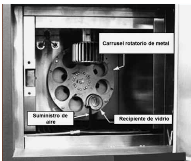
Figura 1. Horno de película rotatoria delgada (RTFO).
