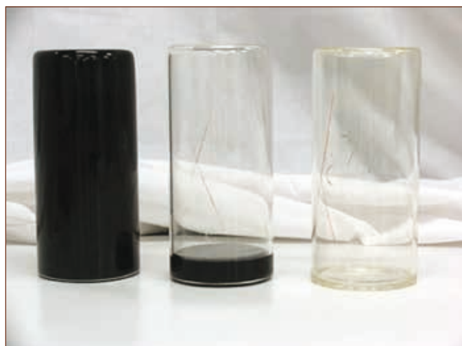
Figura 3. Frascos de RTFO en las diferentes etapas del ensayo.
