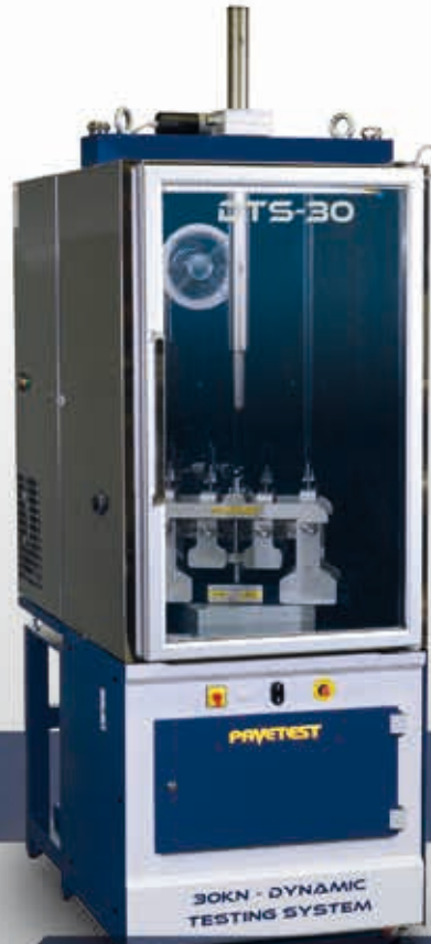
PRENSA SERVO-HIDRÁULICA 30 KN, MÓDULO DINÁMICO (NIVEL III)
