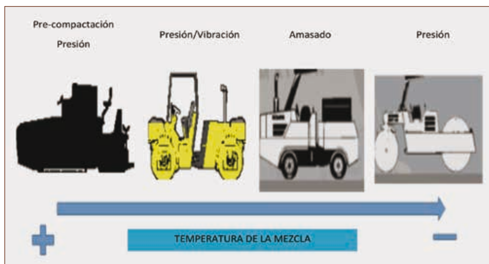
Figura 4. Características del tipo y equipo de compactación.
