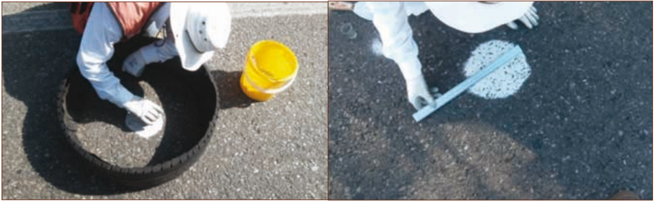
Figura 2. Método de círculo de arena para determinar macrotextura.
