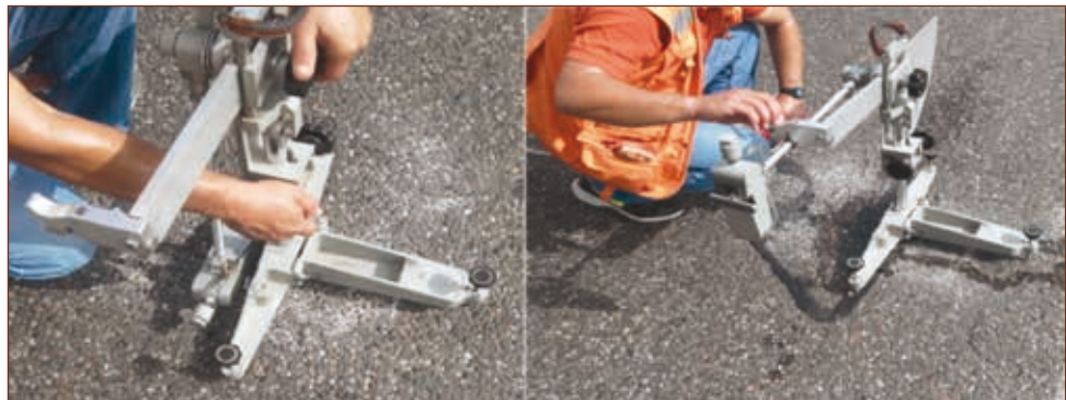
Figura 3. Método de péndulo británico para determinar fricción.
