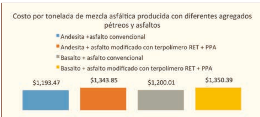
Figura 3. Costo por tonelada de mezcla asfáltica, análisis en el que se consultaron costos de los materiales y se asumieron costos de producción basados en el mercado actual, por lo que los costos son aproximados y no representan un costo fijo de algún proveedor de mezcla asfáltica.
