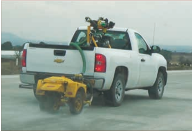
Figura 4. Equipo Mu meter para determinar fricción.
