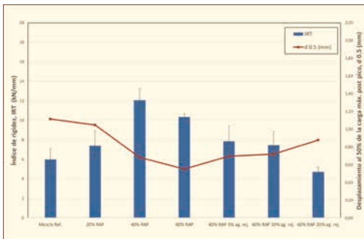
Figura 5. Índice de rigidez a tracción y desplazamiento al 50% de la carga máxima post pico, ensayo Fénix a 20 °C.
