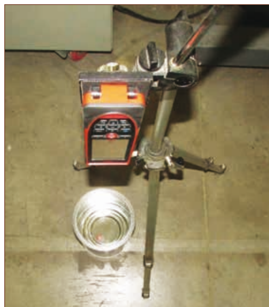
Figura 4. Distanciómetro láser para la medición de coeficiente de expansión y vida media del espumado.
