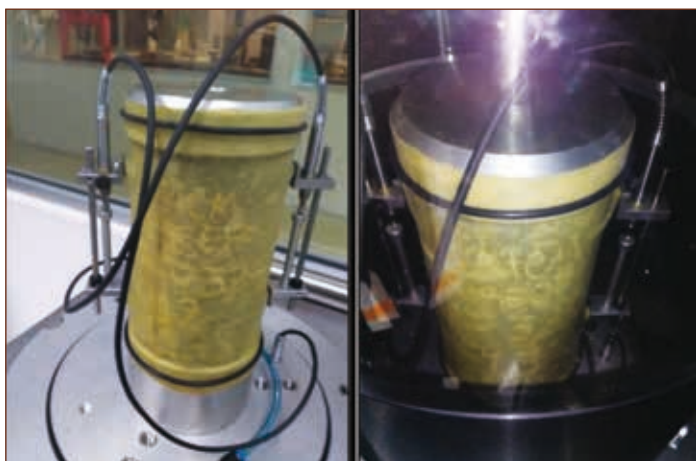
Figura 6. Prueba Deformación Permanente Triaxial Cíclica. Montaje de espécimen con LVDT's sobre membrana (izquierda) y espécimen durante prueba (derecha).
