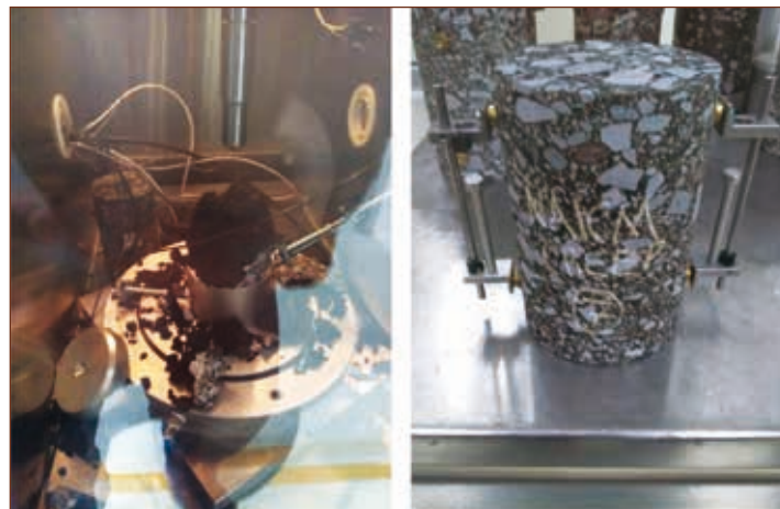
Figura 11. Especímenes después de la prueba de creep estático @60 °C. Asfalto AC-20 (izquierda) y Asfalto PG82-16 (derecha).
