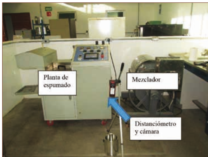
Figura 2. Equipo de espumado completo que lo conforma: dispositivo de espumado, mezclador de aspas y distanciómetro láser.
