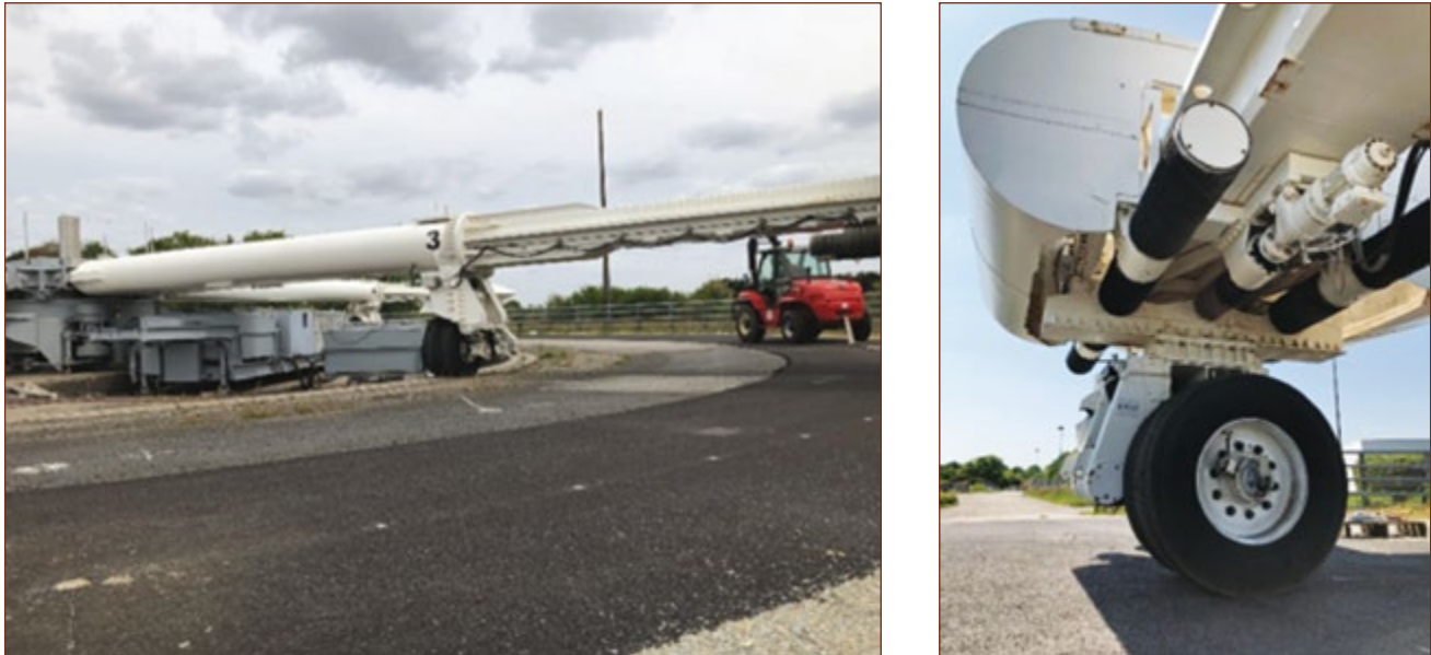
Figura 2. Dispositivo de prueba para ensayos acelerados de pavimentos, IFSTTAR.
