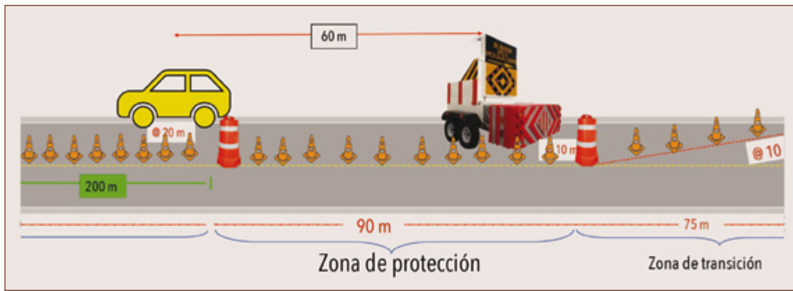
Figura 8. Zona de protección con amortiguador de impacto.
